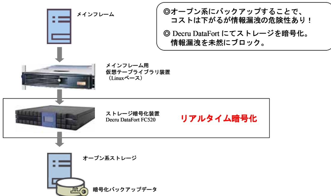
バステック社の仮想テープ・ライブラリ装置はLinuxをベースにしたアプライアンス製品であり、メインフレーム向けに ESCON/FiCON インターフェースを持ち、最大 64 台分の 3480/3490 テープ・ドライブをエミュレートできます。その一方でオープン系インターフェースとして、最大 2 チャンネルのファイバー・チャネルと Ultra 320/LVD SCSI、デュアル構成の 10/100/1000Mbps のイーサネット・ポートを持ち、多様なオープン系ストレージに接続できます。この装置をメインフレームとオープン系ストレージの間に設置することで、メインフレーム側には全く手を入れることなく、安価なオープン系ストレージを 3480/3490 テープ・ドライブとして利用できます。なおこの製品はすでに米国 IBM の認定も受けています。
